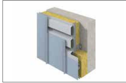
Elewacja wentylowana Podkonstrukcja metalowa
